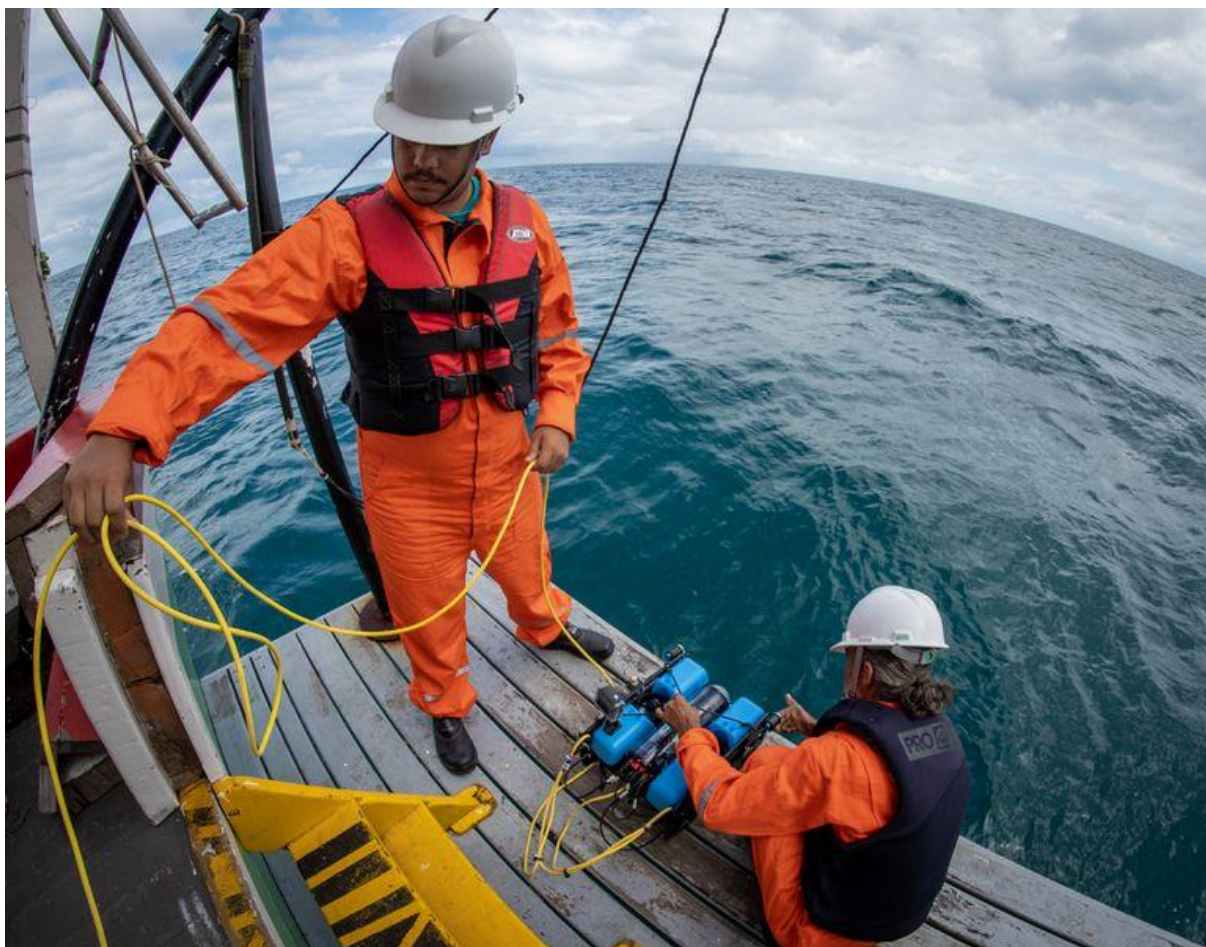
Figura 4: Operação de coleta de dados com ROV.
